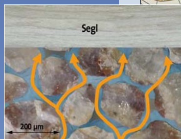
Figur 1 Den injicerede CO 2 , der er lettere end vand, stiger opad og stoppes af det overliggende og uigennemtrængelige segl.
