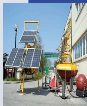
Figur 2 Overvågningsbøje med solpaneler, der leverer energi, flydere og udstyr, som tager gasprøver ved havbunden.
