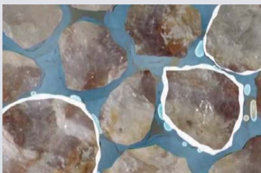
Figur 2 Komprimeret CO 2 stiger opad (lyseblå bobler), opløses og reagerer med sedimentkomene, hvilket fører til at kalk udfældes på kornene (hvidt).
