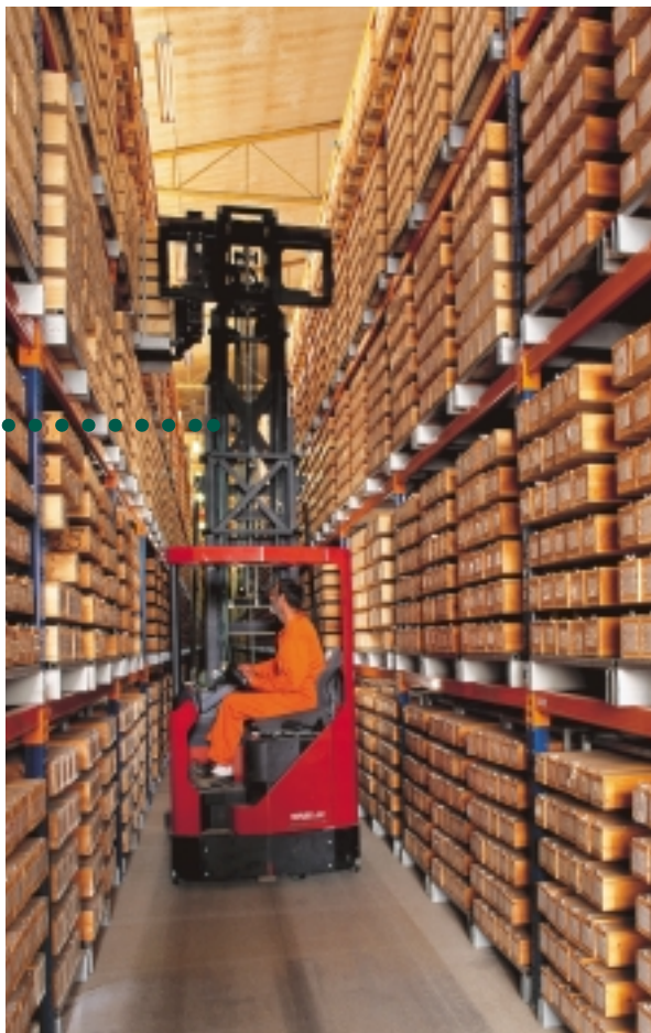
Fig. 3 Den elektrisk styrede "smalgangstruck" i arbejde mellem reolerne med paller.
