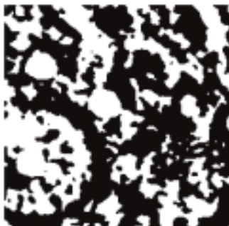
Fig. 9 Billede af en poleret overflade af et stykke kridt optaget med SEM (ca. 40x40 \mu\text{m} ) som viser porerum (hvid) og matrix (sort). Til venstre i billedet ses en ringformet struktur som er et snit i en coccolit.
