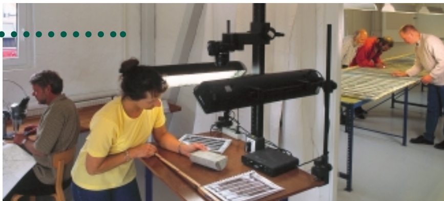
Fig. 5 Besøgslokalerne, hvor der er fremlagt borekerner til besigtigelse på lange borde; der ses en opstilling til fotografering af borekerner og et arbejdsbord med mikroskop til nærmere undersøgelse af boreprøver eller cuttings.
