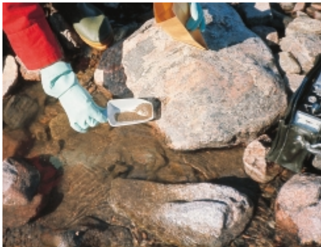
Fig. 3 Indsamling og analyse af finsand aflejret i bække er GEUS' vigtigste metode til at indkredse områder med guldmineraliseringer. Når de omgivende bjergarter smuldrer som følge af årtusinders vejrpåvirkning vil guldkorn fra eventuelle guldforekomster efterhånden have på bunden af bækkene.
