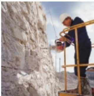
Fig. 1 Billedet er fra Sigerslev kridtbrud på Stevns. Ved hjælp af en boremaskine udbores der borekerner af kridt til senere studier i laboratoriet. Ved hjælp af avanceret udstyr bliver variationen af kridtprøvernes fysiske egenskaber bestemt. Resultaterne gør det muligt at beskrive kridtets regionale petrofysiske egenskaber; dermed kan der siges noget om kridtets reservoir egenskaber for olie og gas.
