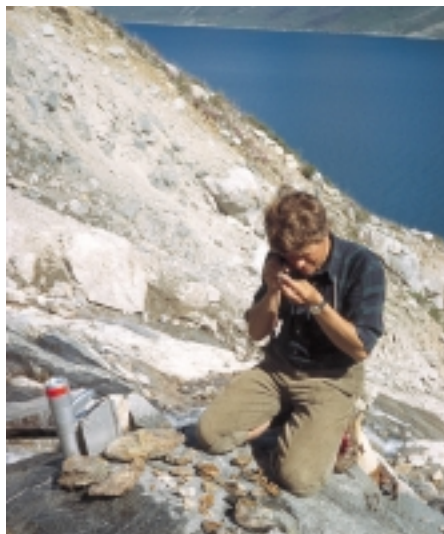
Fig. 7 Undersøgelse af radioaktive mineraler med lup. Apparatet til venstre for geologen måler gammastråling udsendt af mineraler der er rige på uran, thorium eller kalium.
