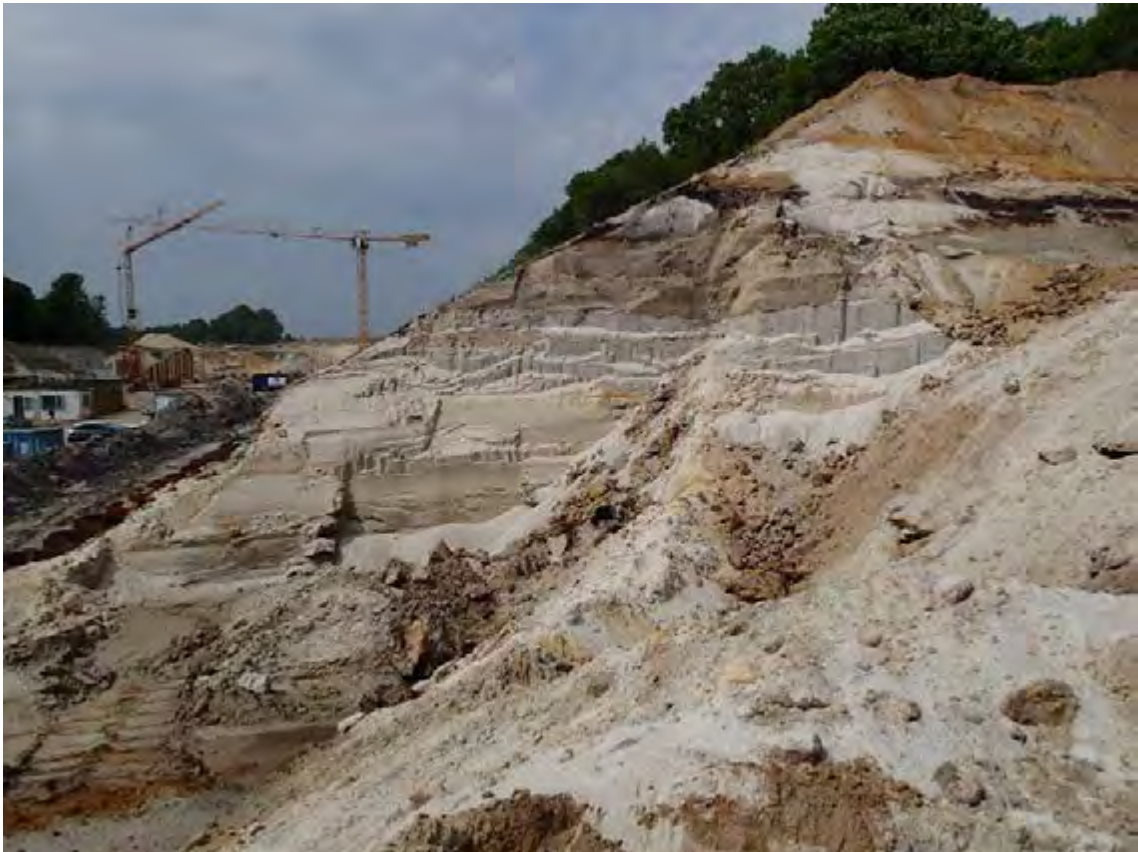
Figur 28. Det øverste miocæne lag er krydslejret kvartssand, der er overlejret af et 20 cm tykt sort, siltet lerlag. Oven over det er der miocænt præget smeltevandssand.
