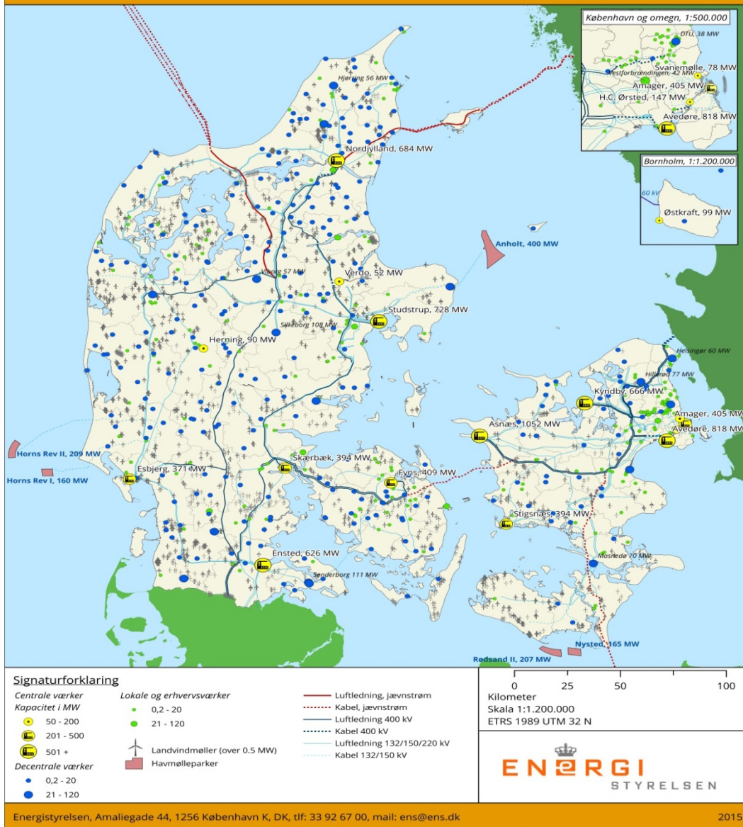
Figur 14.1. El-infrastrukturen i Danmark i 2015 (Fra Energistyrelsens hjemmeside).
