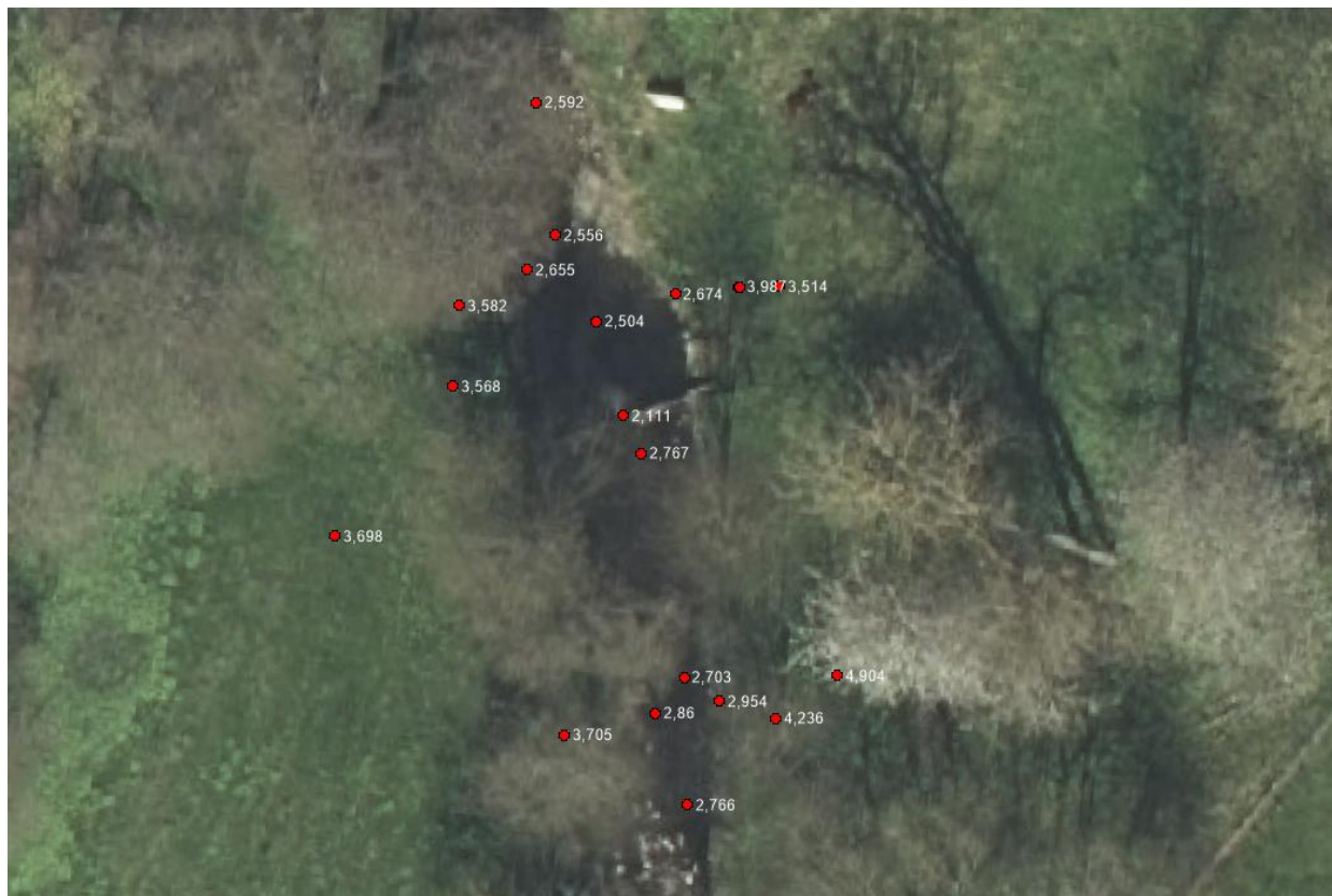
Figur 5: Kotemålinger ved spærringen i Kobbe Å. Målt d. 23-09-2025. Luftfoto fra foråret 2025.
