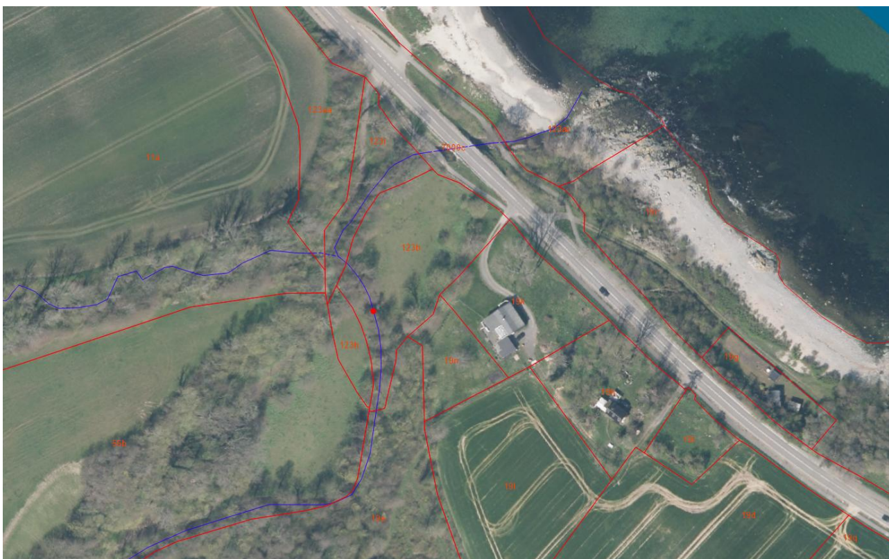
Figur 1: Oversigtskort over projektet. Vandløbets forløb er vist med mørkeblå streg og spærringen er markeret med en rød prik. Matrikelgrænserne er vist med røde streger og matr.nr. kan ligeledes aflæses. Luftfoto fra foråret 2024.
