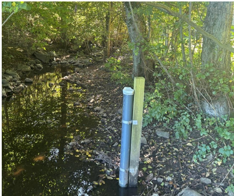
Figur 11: Skalapæl med logger der står opstrøms spærringen. Billede taget d. 23-09-2025 af Christina Mortensen.
